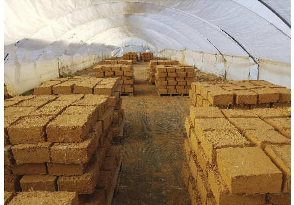
Tras investigar los modos de arquitectura de la zona, y utilizando técnicas y materiales usados tradicionalmente para edificar, proyecta construir una casa con ladrillos de adobe, que fabrica con el barro que extrae del propio emplazamiento.
