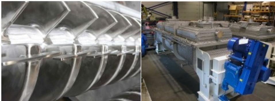
Figura D. Secador/refrigerador de eje de cuchilla doble
