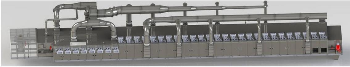
**Figura I. Instalación de secado industrial (directo de banda)**
