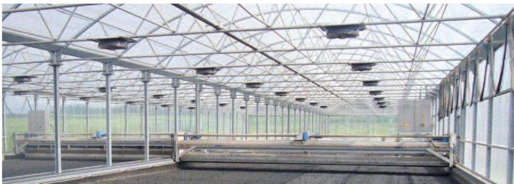
**Figura 12 - Secador tipo invernadero con sistema regenerativo (HUBER Technology, 2001).**
