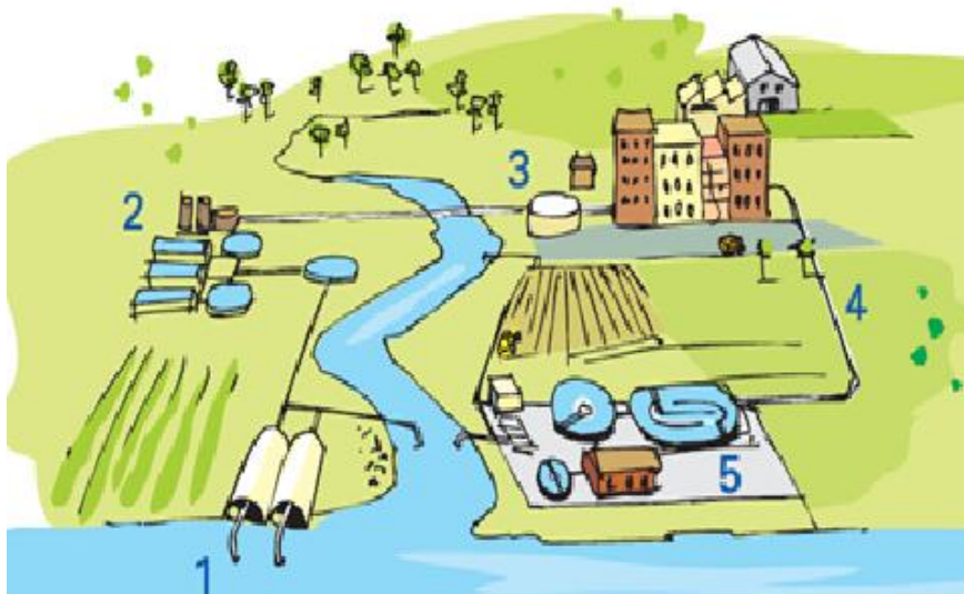
Figura 9 1-Captação; 2-Tratamento de água (ETA); 3-Consumo; 4-Recolha da água residual; 5 - Saneamento (ETAR)
