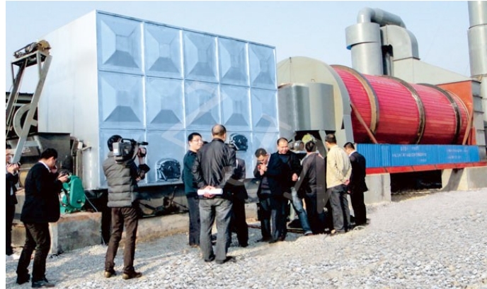
Figura O. Instalación de secado industrial (directo rotativo)
