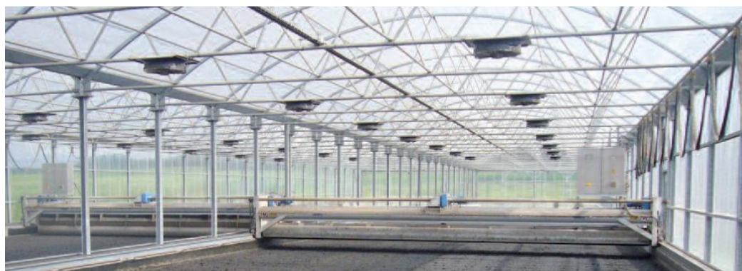
Figura 12 - Secador tipo invernadero con sistema regenerativo
