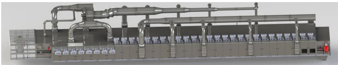
Figura I. Instalação de secagem industrial (direto de banda)
